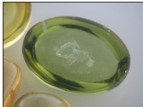
Fig. 4 – Particolare della superficie dell’“ ambra verde ” dopo il test dell’alcol puro.
