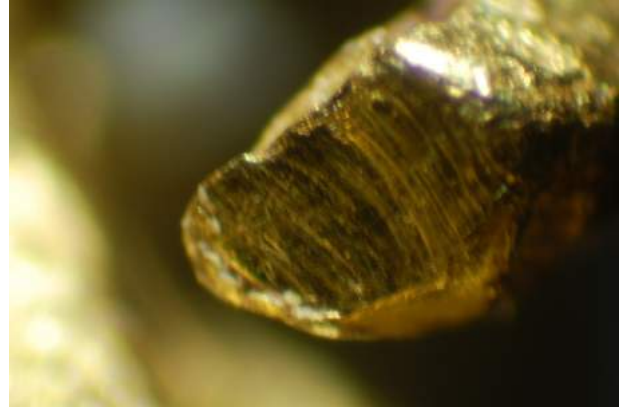
Fig. 9 - Particolare della troncatura del filo d'oro eseguita con un utensile a scalpello.
