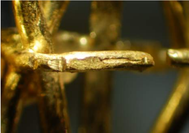
Fig. 12 - Segni di forzatura impressi dall'utensile sulle griffe; si notano i microsolchi causati da una non perfetta lucidatura dell'utensile impiegato.
