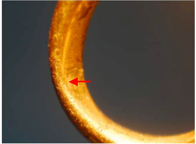
Fig. 9 - Zona consumata del filo, particolare della figura 8
