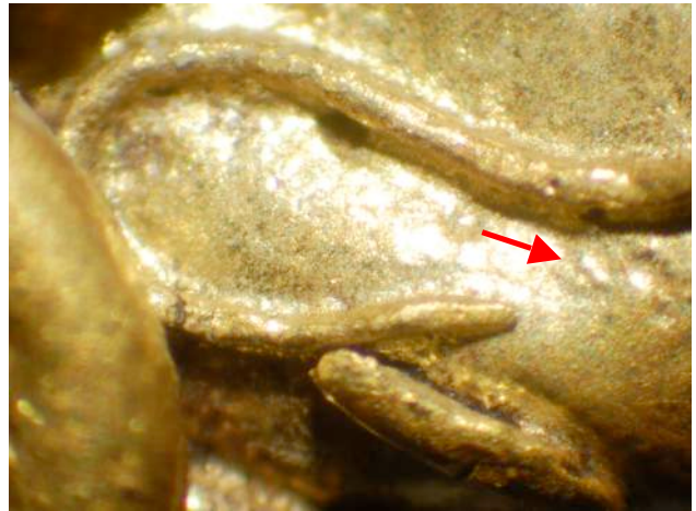
Fig. 5 - Residui di lega saldante, particolare della figura 2
