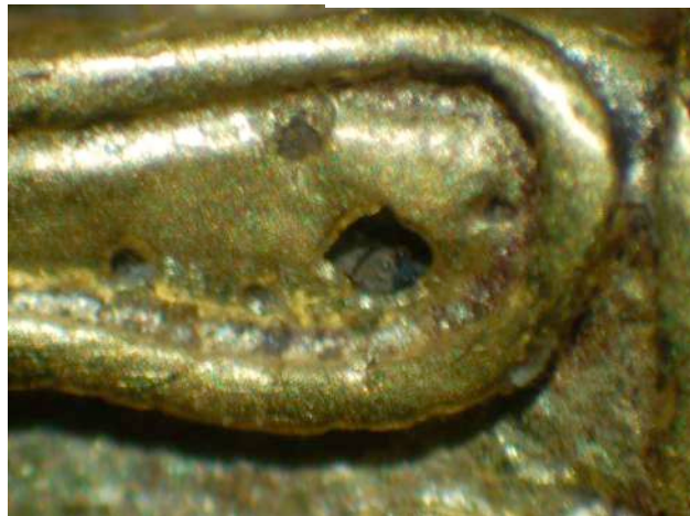
Fig. 10 - Piccole lacune della lastra causate dall'eccessivo calore nella fase di saldatura del filo ritorto. La superficie del filo è consumata dal lungo uso del monile
