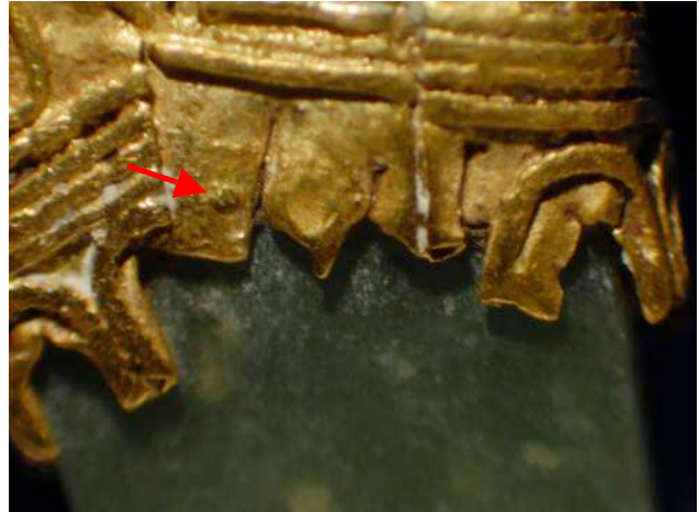
Fig. 3 - Residui di lega saldante (ingrandimento a 10x)
