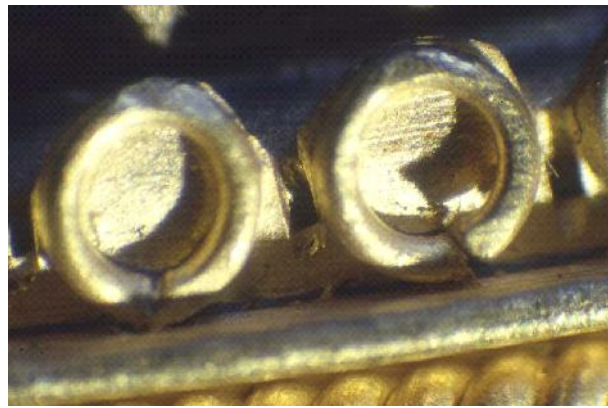
Figura 7 – Particolari di vari tipi di griffes a “dentello”.
